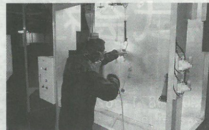
塗装前のエアブロー工程
