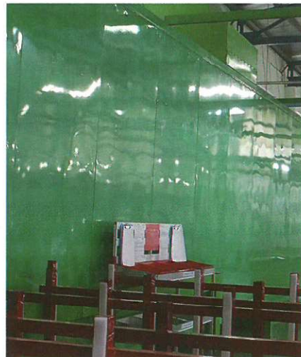
大型部品の焼付にも十分対応できる乾燥炉
